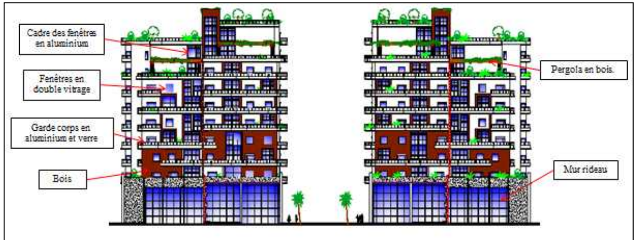
Fig. 49.03: matériaux utilisés dans la façade.
