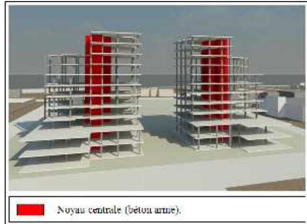
Fig. 52.03 : Ossature du bâtiment (structure mixte, acier/béton)
