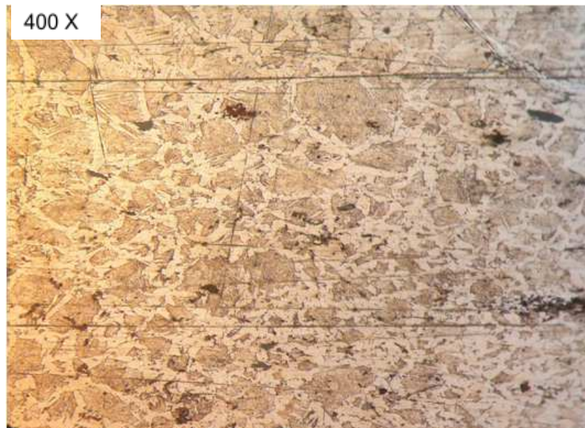
Figure 3.6 : Zone affectée thermiquement (baguette 7018 + Cobaltec)
