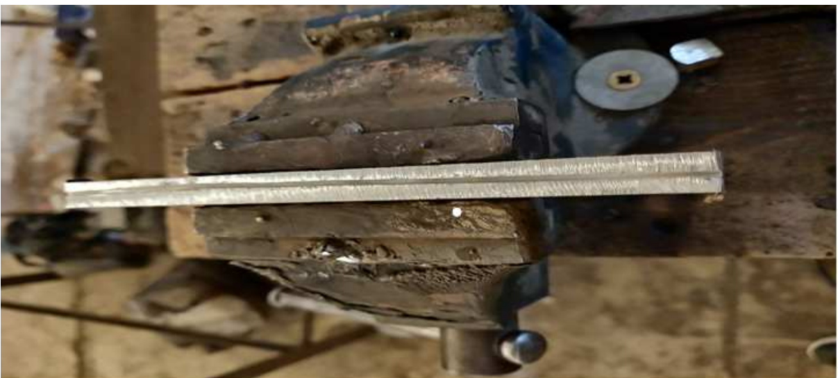
Figure 3.2: Création d'une fissure dans la barre en acier.
