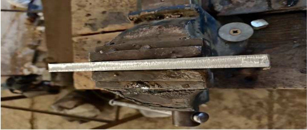
Figure 3.1: Baguette de base carrée après nettoyage de sa surface.
