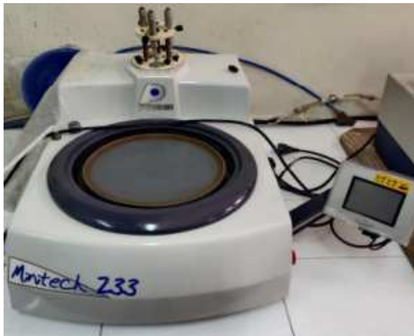
Figure 2.1 : Polisseuse de finitionPRESI MINITECH 233
