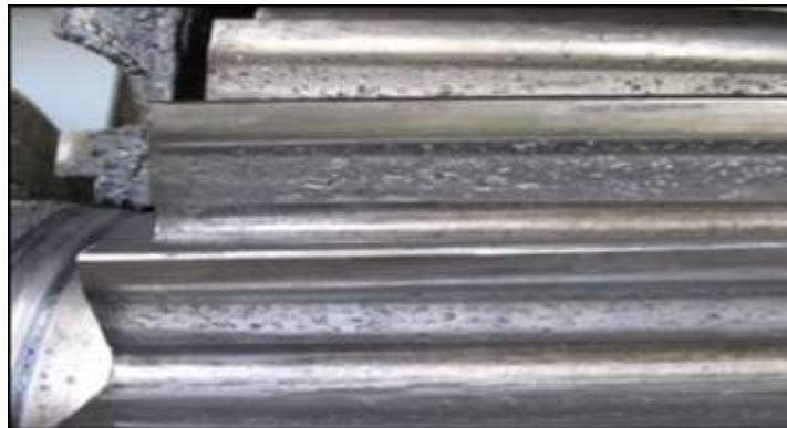
Figure.II.13 : défaut les piqûres [10]
