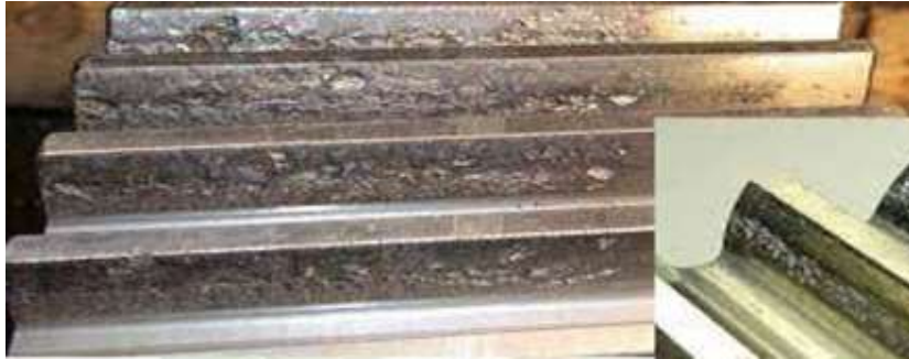
Figure.II.12 : défaut des usures. [10]
