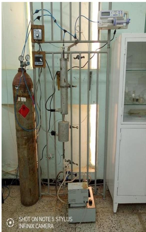
**Figure 2.6 :** Dispositif expérimental de reformage catalytique du glycérol.
