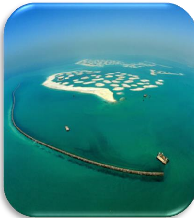
Fig.2. Les ouvrages longitudinaux des Basse plage et de petit fond
