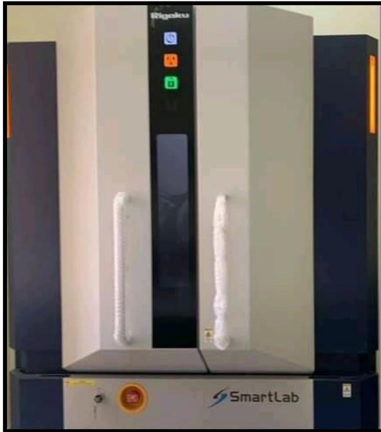
**Figure C.2:** Appareil de diffraction des rayons x (DRX).
