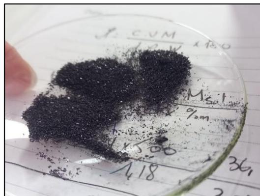
Figure 11 le graphène oxydé après broyage.
