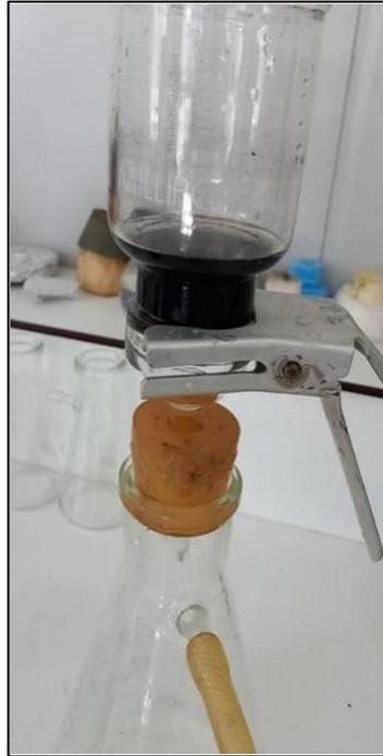
Figure 10: filtration de la solution de graphène
