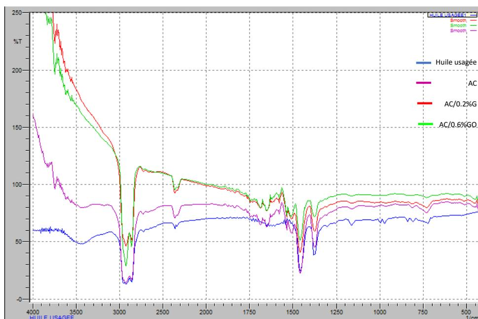
Figure 28: les spectres IR de la membrane AC/ 0.2% (G), AC/ 0.6% (GO), huile usagée
