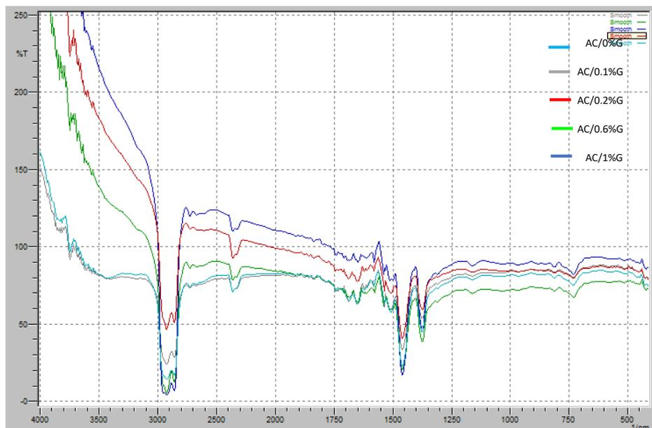
Figure 26: les spectres IR de la membrane AC/0% (G), AC/ 0.1% (G), AC/ 0.2% (G), AC/ 0.6% (G) et AC/ 1%(G).
