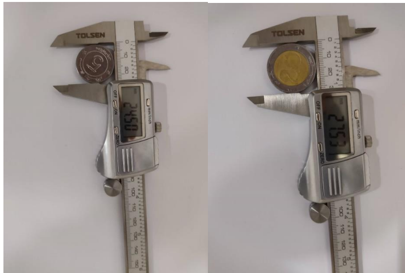
Figure 4.16 : Mesure manuel de diamètre de pièce de monnaie à l'aide de Pied à coulisse
