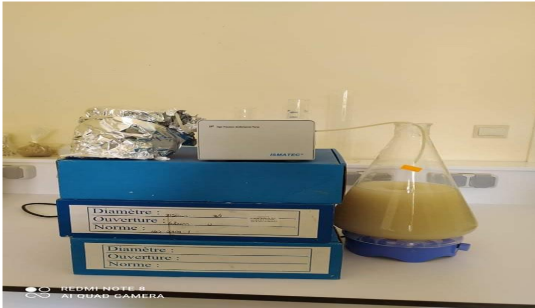
Figure 2.8 : intercalation de l'argile à l'Al
