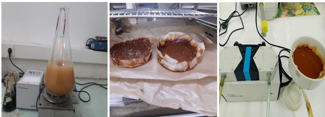
Figure 2.7 : intercalation de l'argile au fer.
