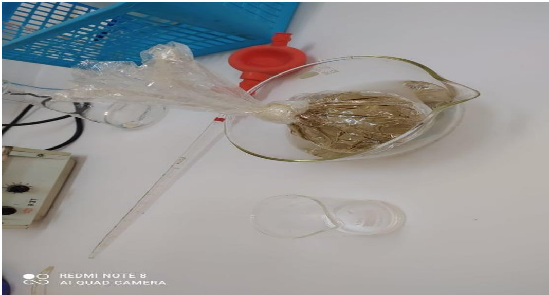
Figure 2.5 : la dialyse de l'argile
