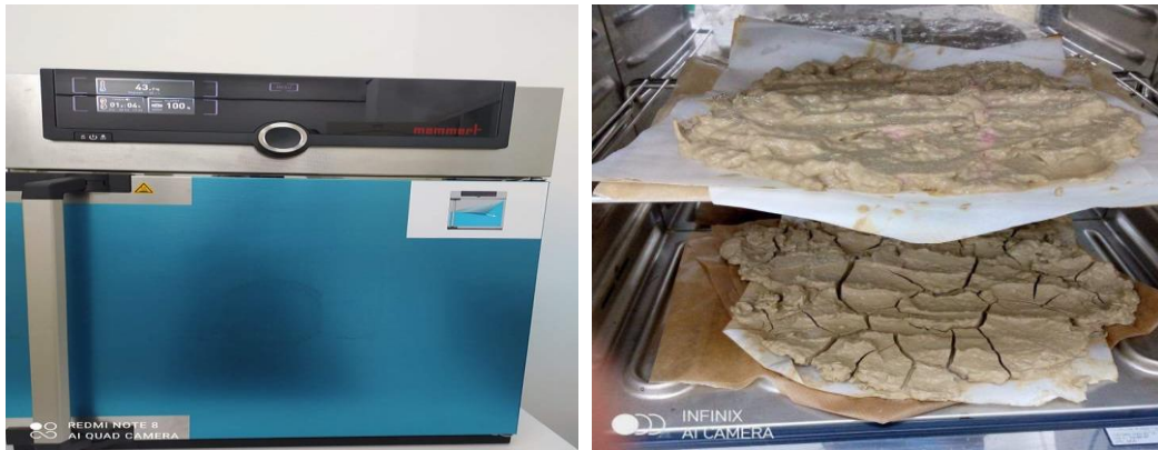
Figure 2.6 : le séchage de l'argile purifiée.
