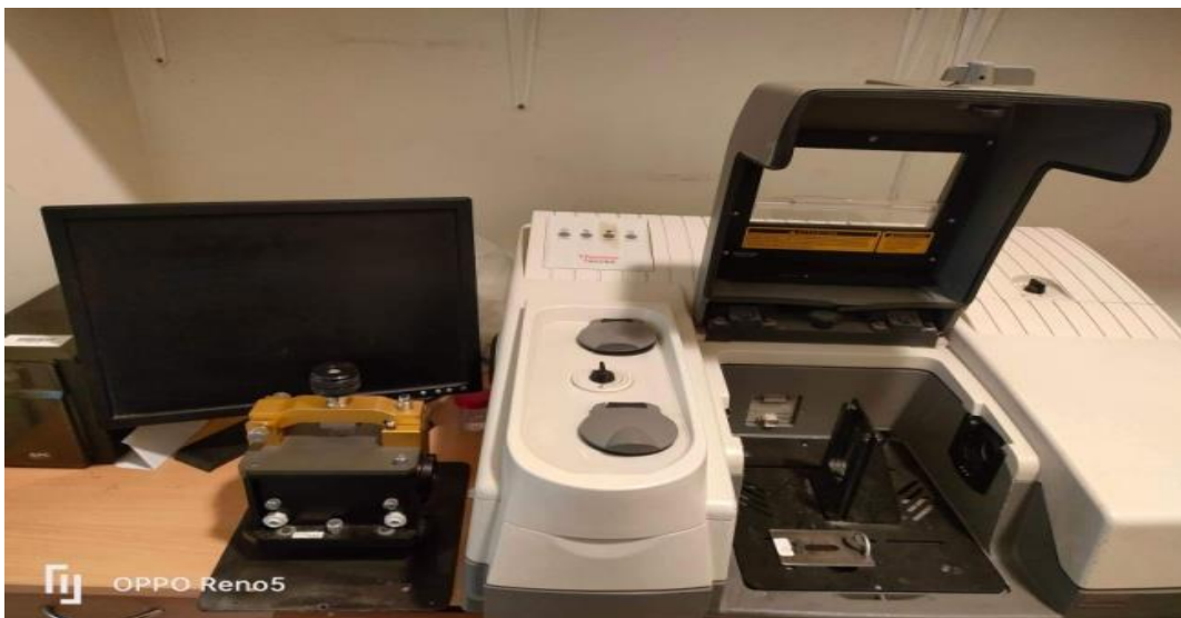
Figure 2.15 : Spectromètre Infrarouge à transformée de Fourier FTIR- Perkin-Elmer 1000
