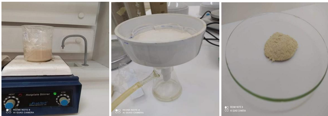
Figure 2.9 : Modification de la montmorillonite par le CTAB.
