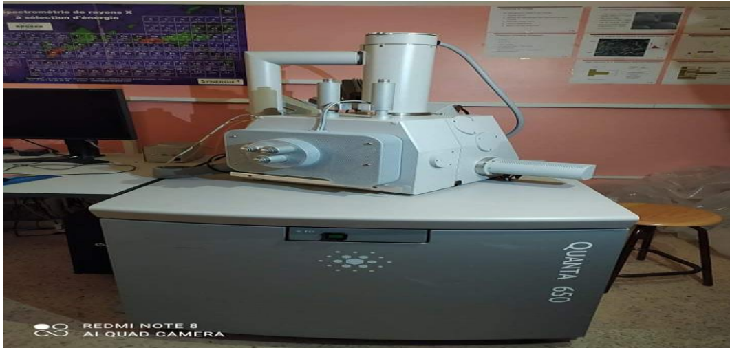
Figure 2.12 : appareil d'analyse MEB.
