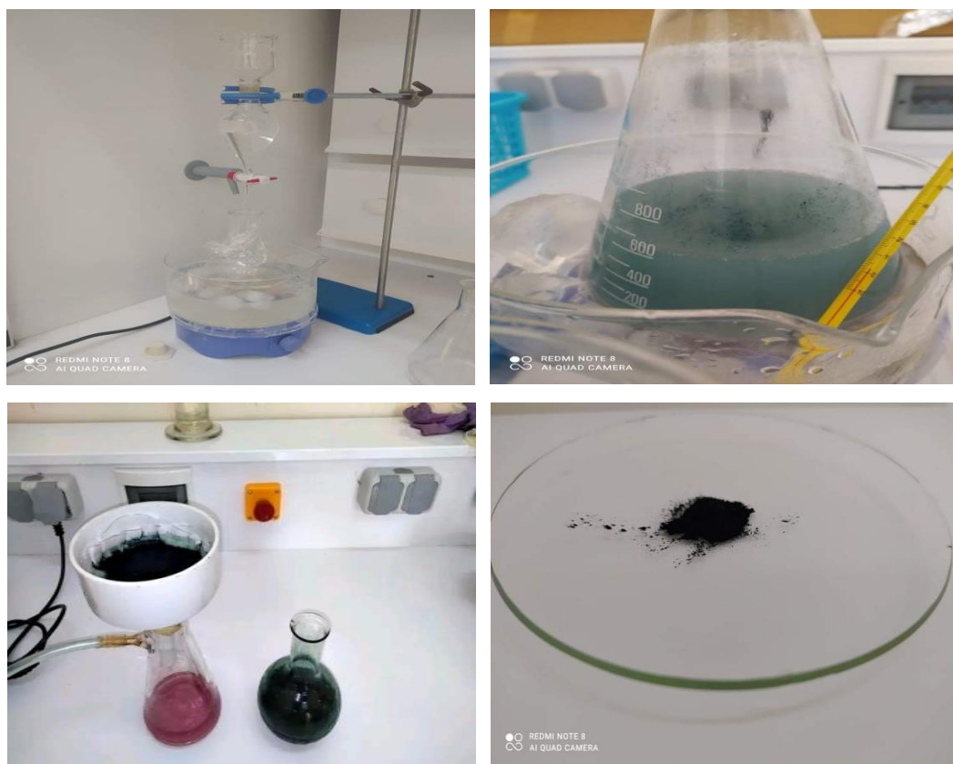
Figure 2.10 : les différentes étapes de synthèse et de filtration de polymère.
