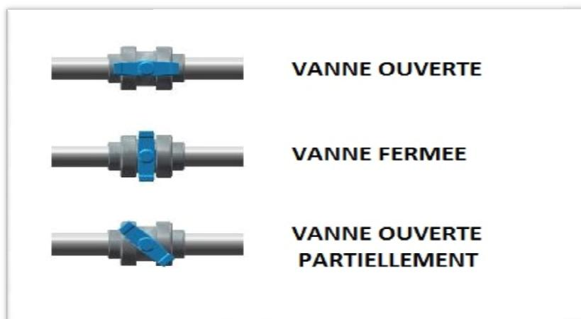
**Figure 16.** Type de vanne de refoulements utilisés
