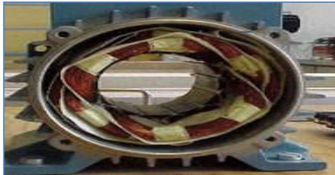
**Figure 8.** Vue générale du Stator
