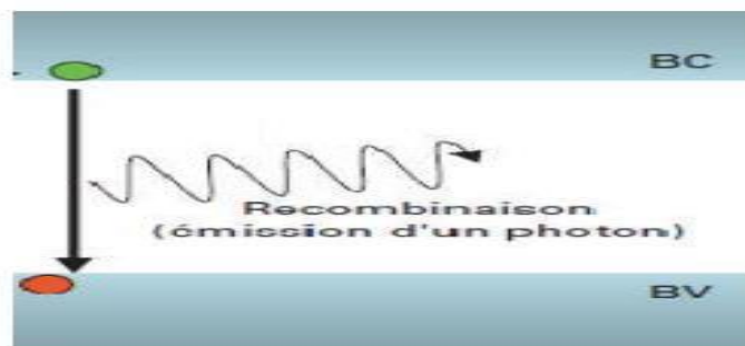
Figure I.10. Schéma représentatif du phénomène de la recombinaison Radiative [14].
