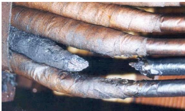
Figure II-7 : Coupure suite à la fusion d'un conducteur
