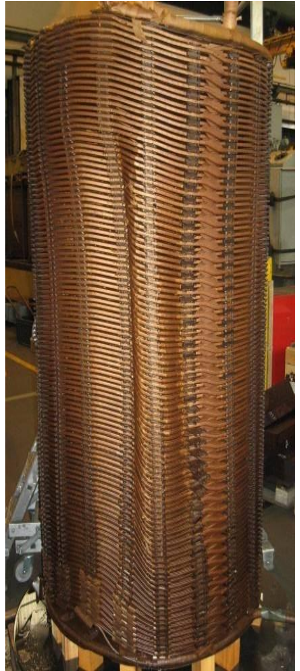
figure II-8 : déformation mécanique d'un enroulement
