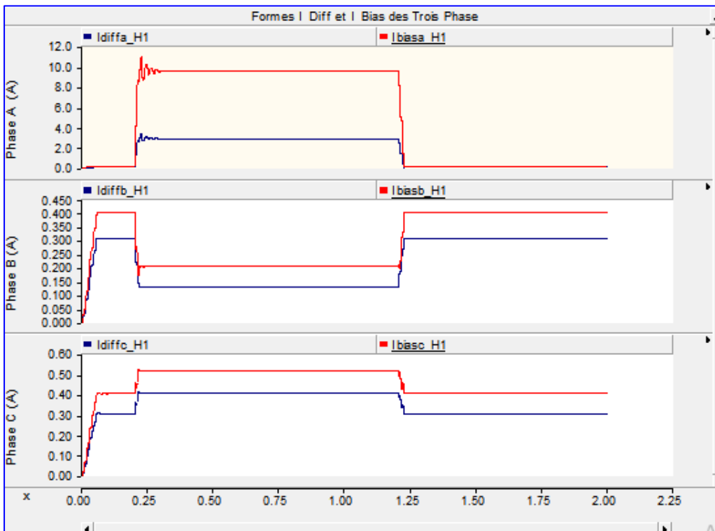
b). Formes des courants IDiff et IRet , des trois Phases.
