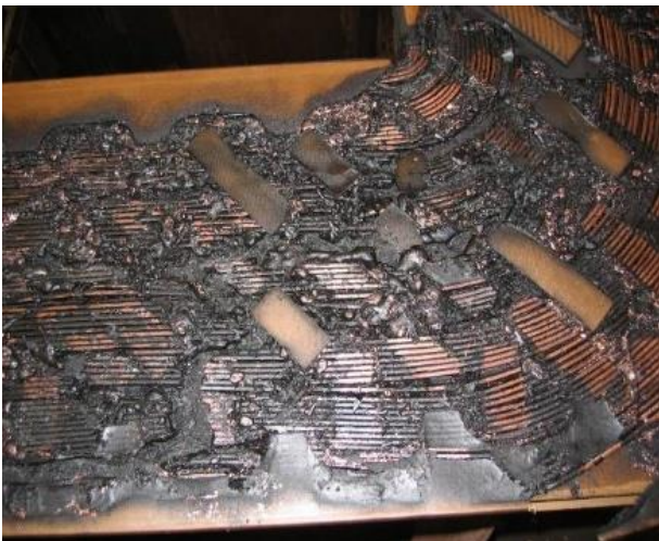
Figure (II-2) : court-circuit entre spires insérable
