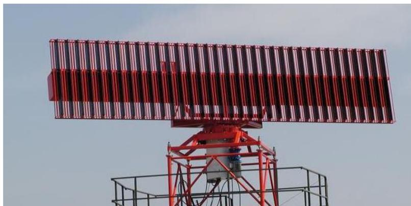
*Figure I.5 : Radar Secondaire*
