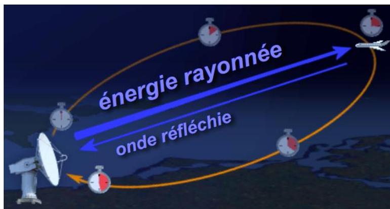
Figure I.3 : Principe du Radar
