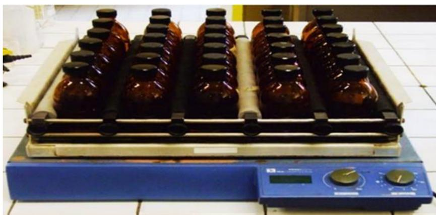
Figure 2.1 : Schéma du secoueur utilisé lors de la cinétique d'adsorption
