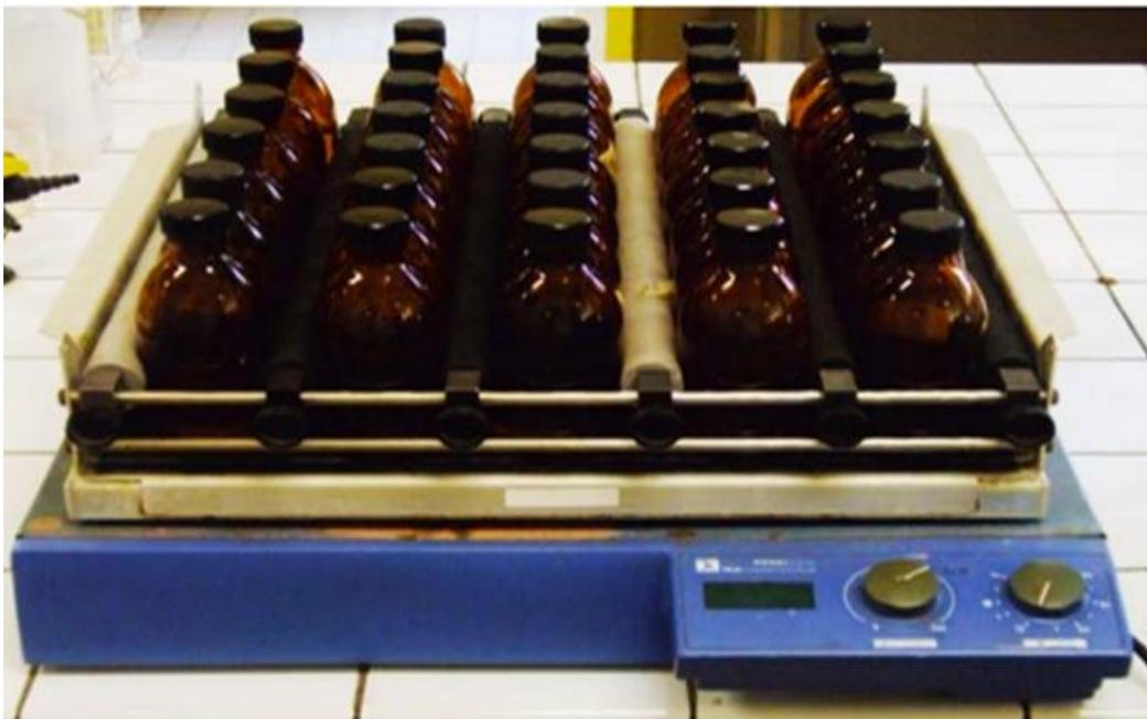
Figure : Secoueur utilisé lors de la cinétique d'adsorption.
