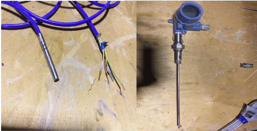
Figure 1.9 Transmetteur de température.
