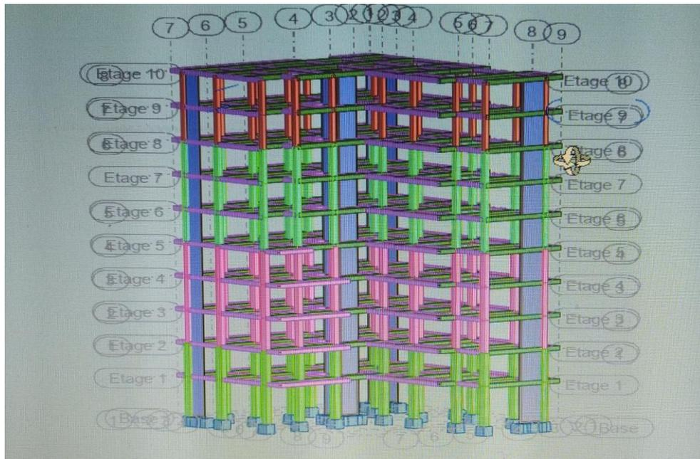
Figure IV. 4 : Vue en 3D du modèle final .
