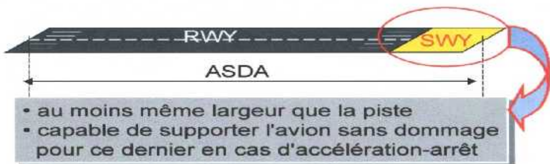
Figure II-35 : Piste doté d'un Stopway
