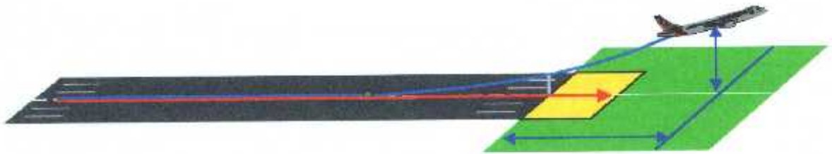
Figure II-34 : Piste doté d'un Clearway Grand
