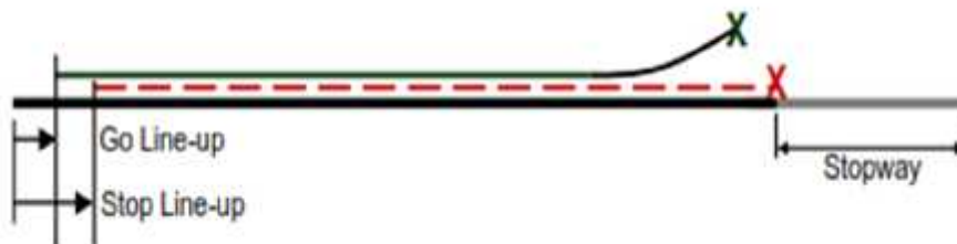
Figure (III-19) : L'effet de la piste avec prolongement d'arrêt sur la vitesse de décollage
