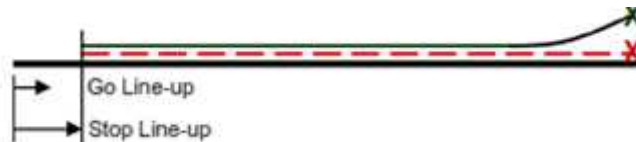
Figure (III-18) : L'effet de la piste son prolongement d'arrêt sur la vitesse de décollage
