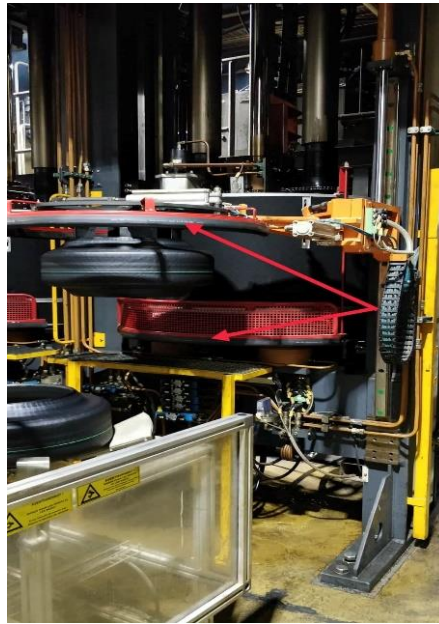
Figure II.8 : Capteur a détection pneumatique.
