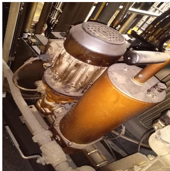
Figure II.29 : Moteur de refroidissement d'huile.
