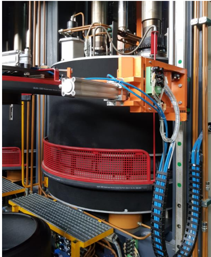
Figure I.18 : La presse commence à se fermer.
