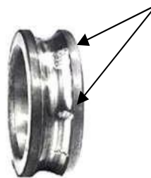
Trous et corrosion dans les gorges
