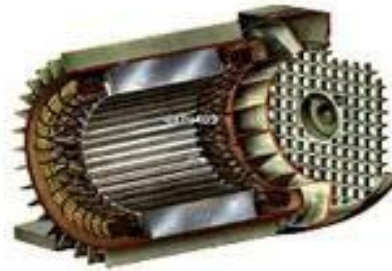
Figure I.1 : Schéma représentative du stator
