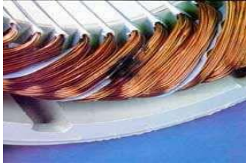
Figure 1.7 : Court-circuit entre phases [8].
