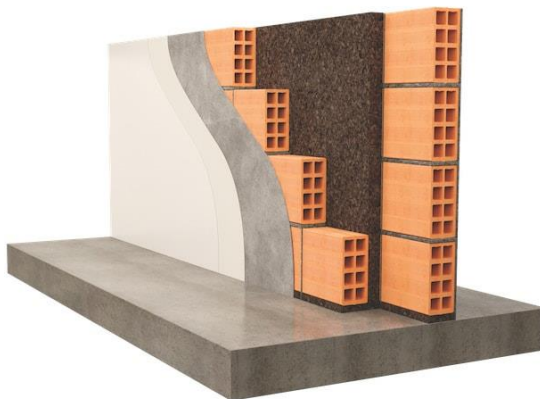
Figure I.7 : Une coupe d'une double cloison
