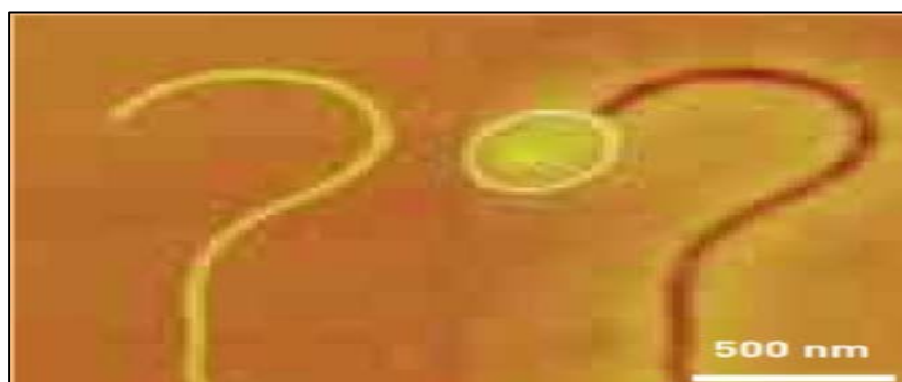
Figure I.14 : A gauche : image de microscopie à force atomique d'un nanotube de carbone
