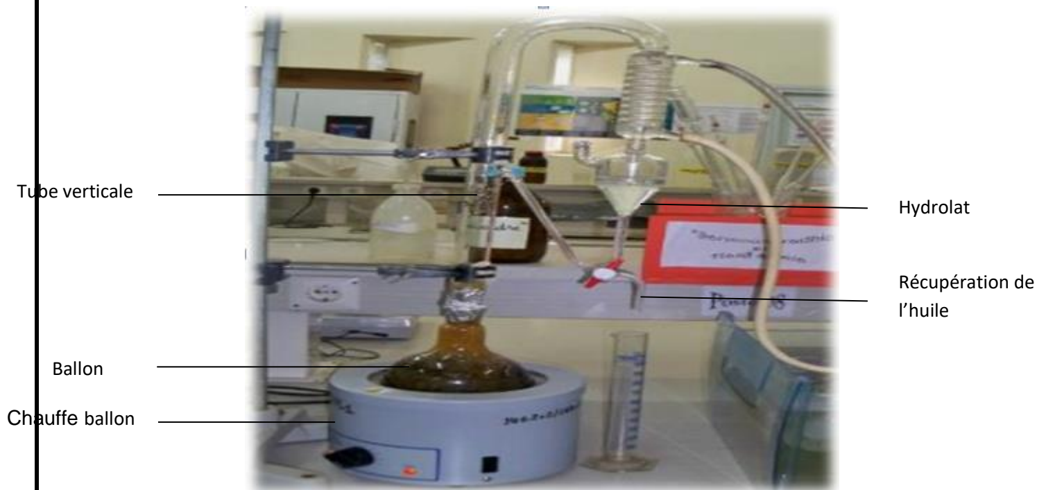
Figure 13 : Dispositif d'extraction d'huile essentielle de lacoriandre de type Clevenger ( Original, 2022 ).
