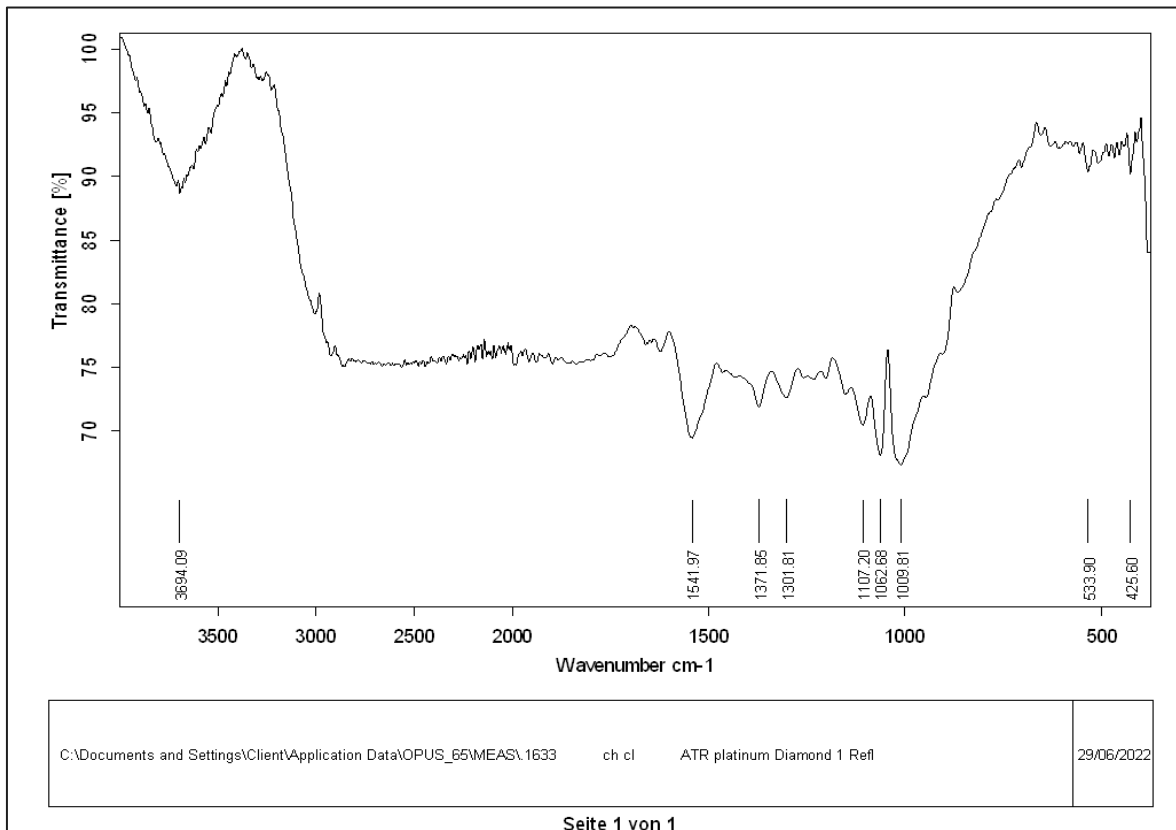
Figure 23 : Spectre FTIR de chitine des plumes de calamars obtenue par méthode chimique
