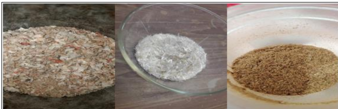
Figure 11 : Lavage et séchage des carapaces de crevette, des plumes de calamar et des criquets
