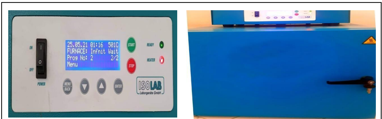
Figure 7 : four a moufle réglé à 500°C ( Originale, 2022 ).
