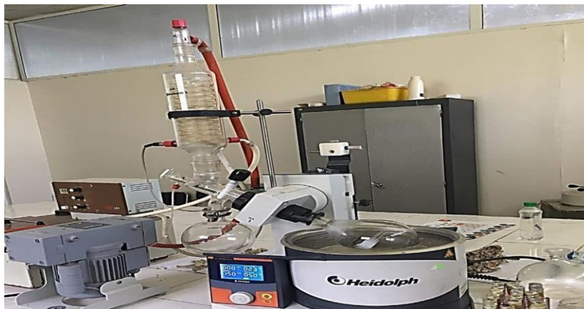
Figure 10 : extrait de fraise filtré et évaporé pression réduite à 50°C au rotavapor (Originale, 2022).
