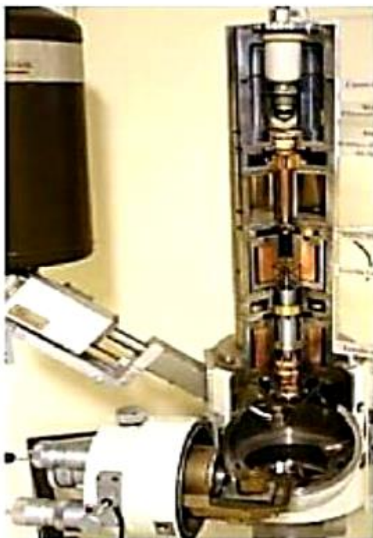
Photo de la coupe d'un MEB et schéma de fonctionnement
