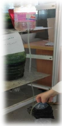
Figure 21 : Séparation des cystes éclos de ceux non éclos par siphonage (la présente étude).
