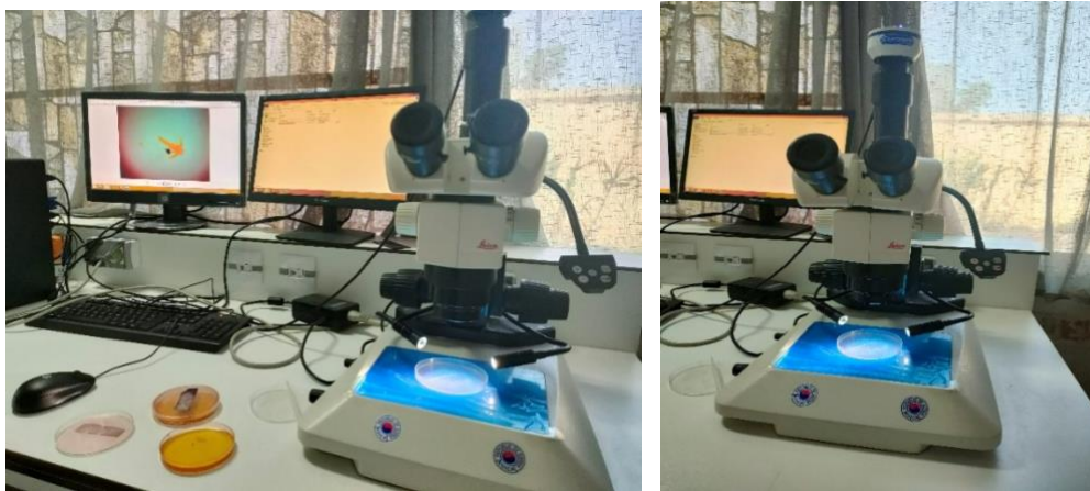
Figure 45 : loupe binoculaire de type Obtika intégré à une caméra de type Oreutek
