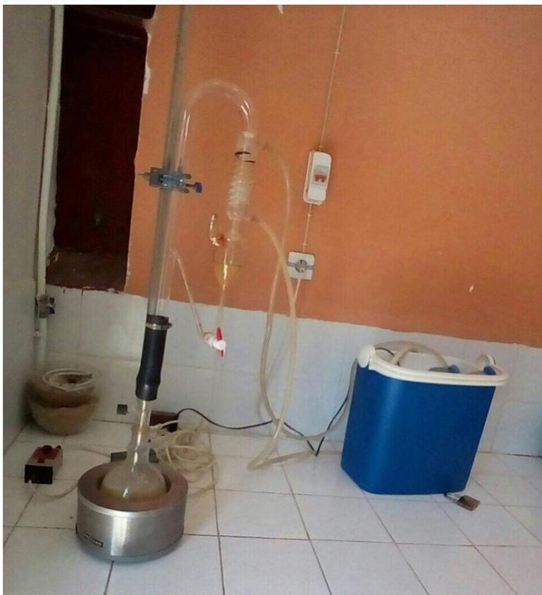
**Figure 21 : Dispositif d'extraction des huiles essentielle par hydrodistillation**
