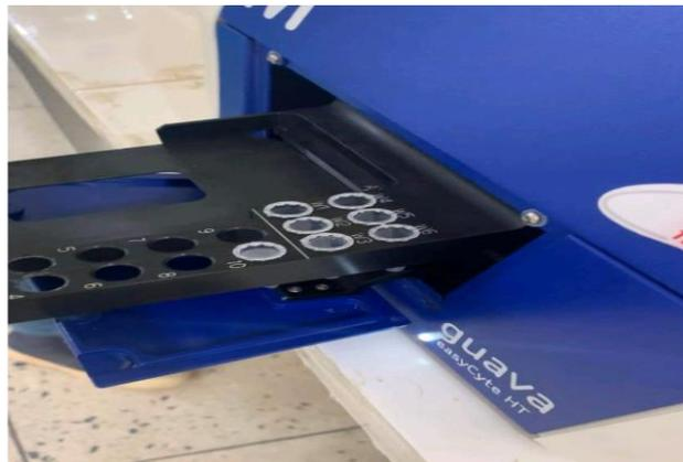
**Figure. 27:** Les différentes positions des tubes pour effectuer un lavage du cytomètre (originale)
