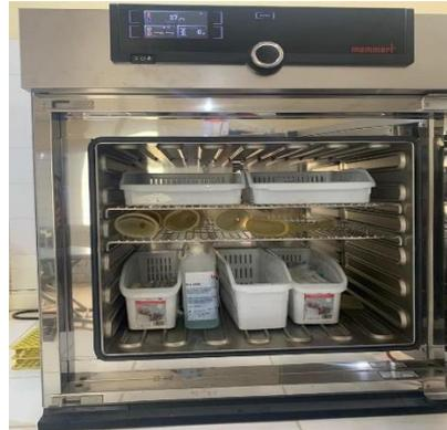
**Figure.19** : Réchauffement des tubes et des cônes en silicone dans l'étuve universelle à convection naturelle UN110 – Memmert, Allemagne (originale)
