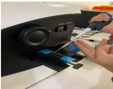
**Etape 4:** 20µl de cet échantillon, sont répartis par capillarité dans une des 4 chambres des cellules de Leja de 20 microns de profondeur (IM technologies, Aigle, France) préchauffés à 37°C.
