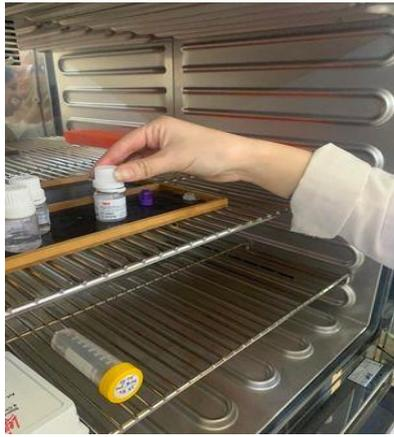
**Etape1:** Incubation du canixCell et de tube de réfrigération identifié et rempli avec l'eau à 37°C
