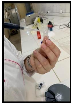
**Etape2:** Remplissage de la cellule de lecture par une goutte de sperme pur à l'aide d'une micropipette de 40µl.
