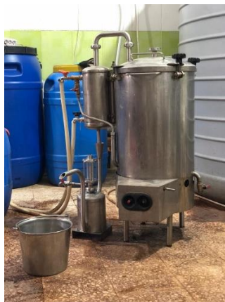
Figure 3.11 : Distillation par entrainement à la vapeur avec un alambic
