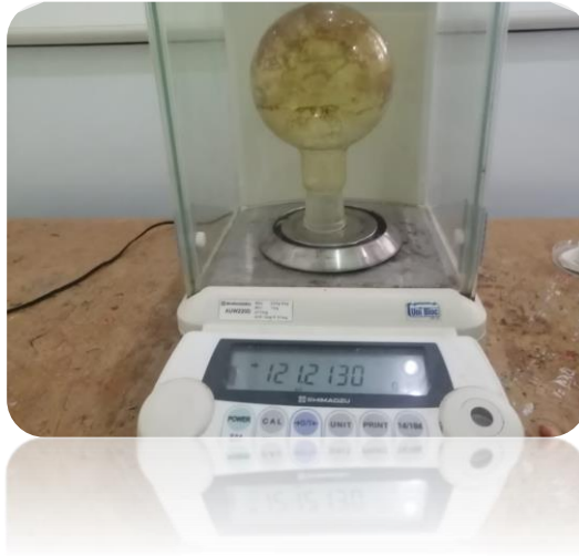
Figure 3-15 : Pesage du poids du résidu sec à l'aide d'une balance de précision.
