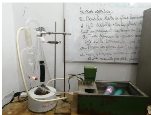
Figure 3-6 : Dispositif d'extraction par hydrodistillation de type clevenger
