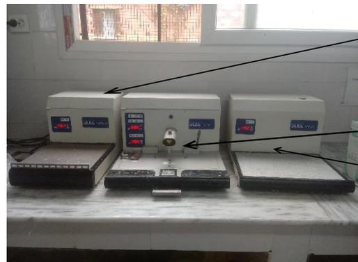
Plaque chauffante pour maintenir la paraffine en fusion. Egalement avec monitoring de la température (SLEE MAINZ MPS/C)
