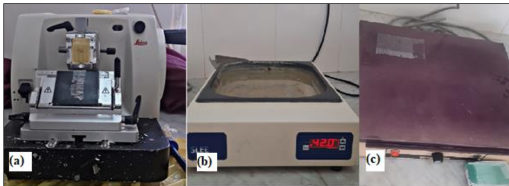
Figure 14 : (a) Microtome, (b) bain marin, (c) plaque chauffants électrique.
