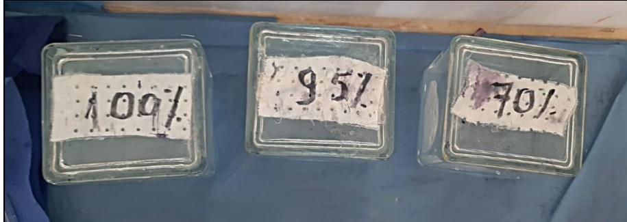
Figure 16: Trois bains d'alcool de degré décroissants.
