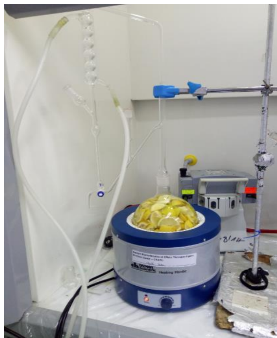
Figure IV.1 : Montage d'hydrodistillation type Clevenger. (Photo originale 2022).
