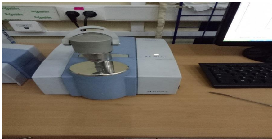
Fig 2 : Spectromètre IR TF la marque ALPHA (Photo originale2022).
