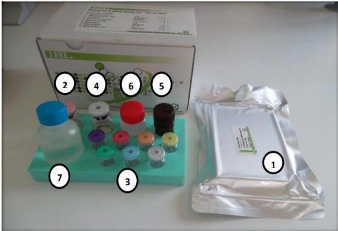
**Figure 12 :** Éléments constituant le kit ELISA IBL pour le dosage sanguin du BPA (1 : plaque de micro-titration à 96 puits, 2 : BPA Conjugué, 3 : Standards, 4 : Anti-BPA antisérum, 5 : Chromogène, 6 : Solution Stop, 7 : Wash buffer) (Anteur, 2016).
