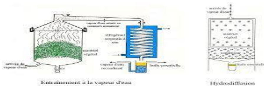
Figure 1.10. Principe schématisé de différentes étapes d'hydro-diffusion (Luchesi, 2005).
