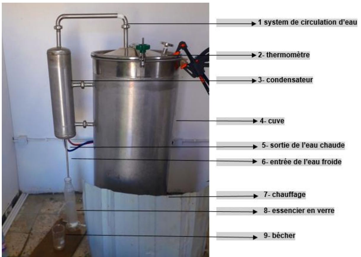
Figure 2.6. Dispositif d'extraction par entrainement à la vapeur d'eau (Original)
