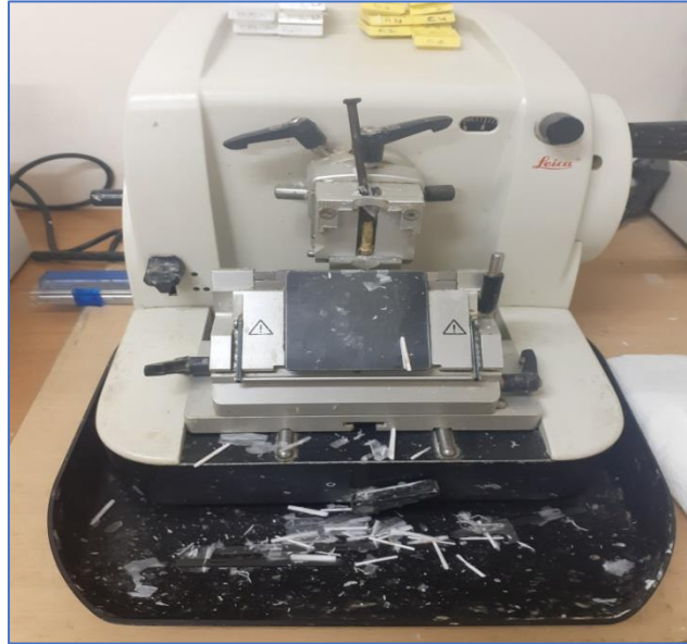
Figure 20 : Le microtome utilisé pour la réalisation des coupes (rubans) (photo originale).
