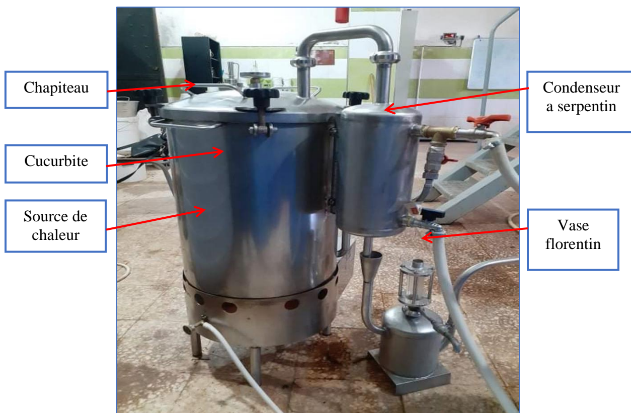
Figure 13 : Appareil de type alambic de 50 litres (photo originale)
