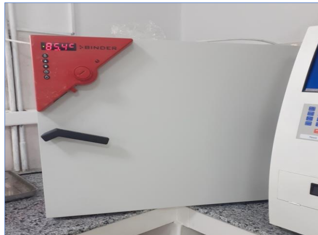
Figure 21: Etuve utilisée pour le séchage des rubans (photo originale)
