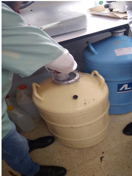
*Figure 12: Cuve d'azote contenant les paillettes de semence caprine.*
