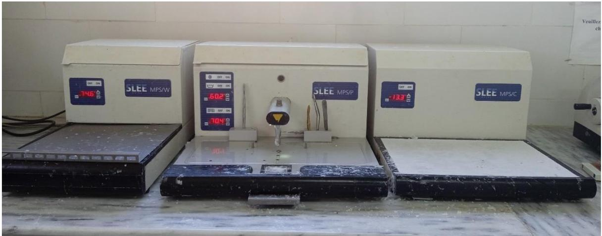
◆ Console thermique, Distributeur de paraffine, plaque réfrigérante de type SLEE
