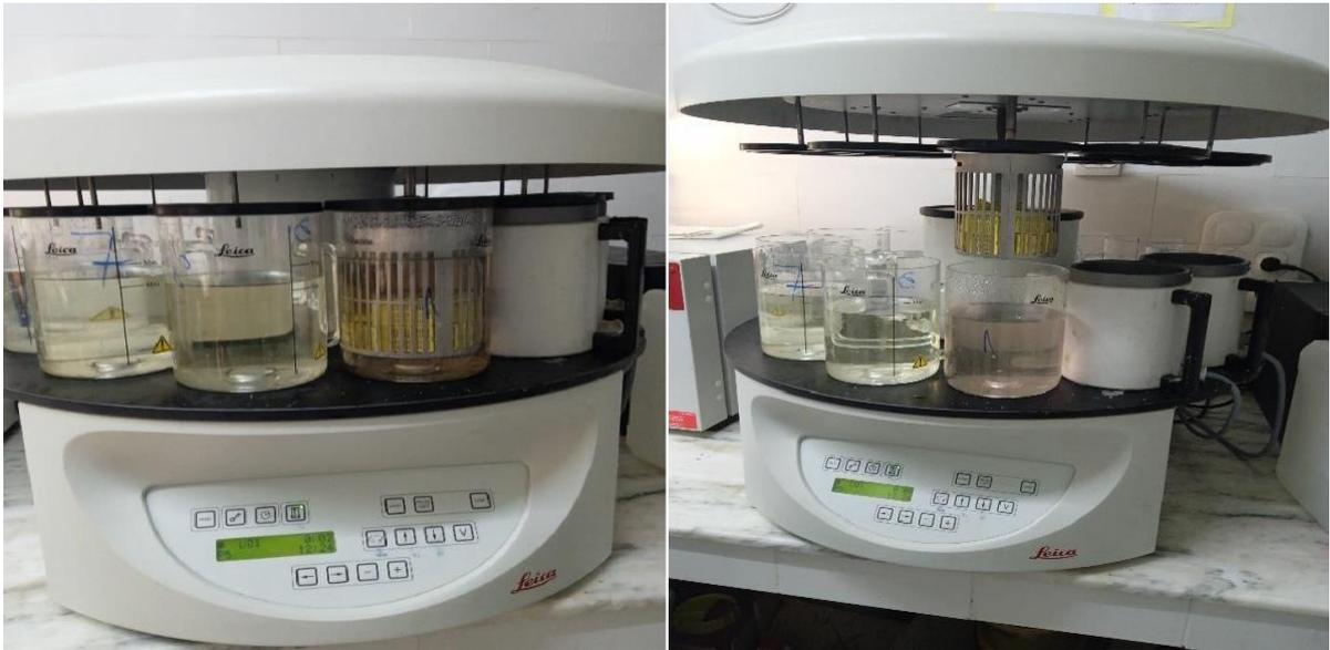
**Figure 14 :** Photographie originale d'un Automate de circulation leica TP 102 au niveau d'EPH de Koléa.
