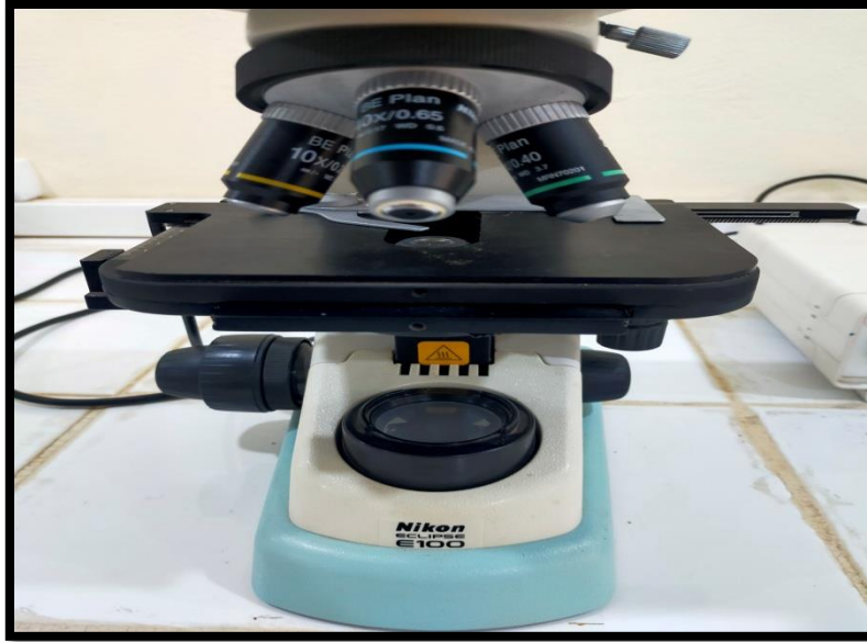
Figure 22 : microscope optique de marque NIKON E100 à platine chauffante
