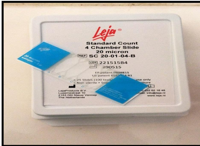
Figure 16: Cellule de Leja® à quatre chambres.
