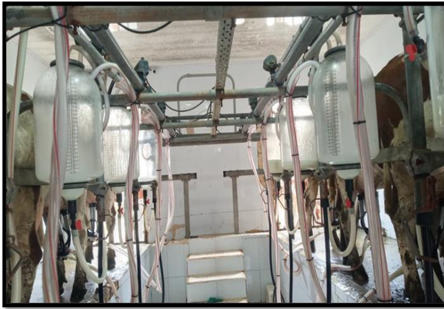
Figure 40 : citerne graduée (photo personnel).
