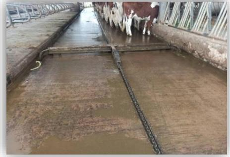
**Figure 8:** Sol en béton avec racleur
