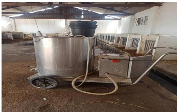
**Figure 20** : Machine de préparation du lait
