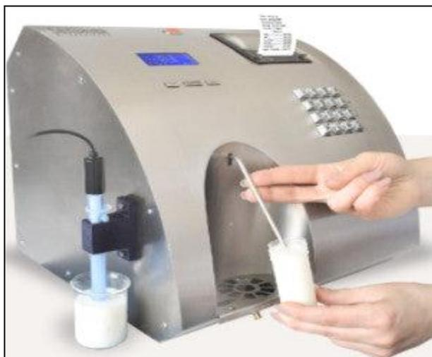
**Figure 8.** Analyseur Lactoscan MCC50 (Laboratoire physico-chimique, USDB1)
