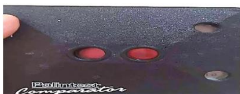
Figure 6 : Résultats du chlore libre =1,0 mg/l mesuré par un analyseur du chlore.
