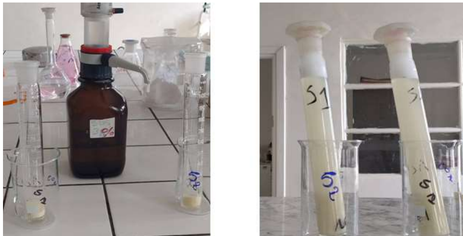
Figure 25 : Photo représentative d'étape de teste de sédimentation (originale)
