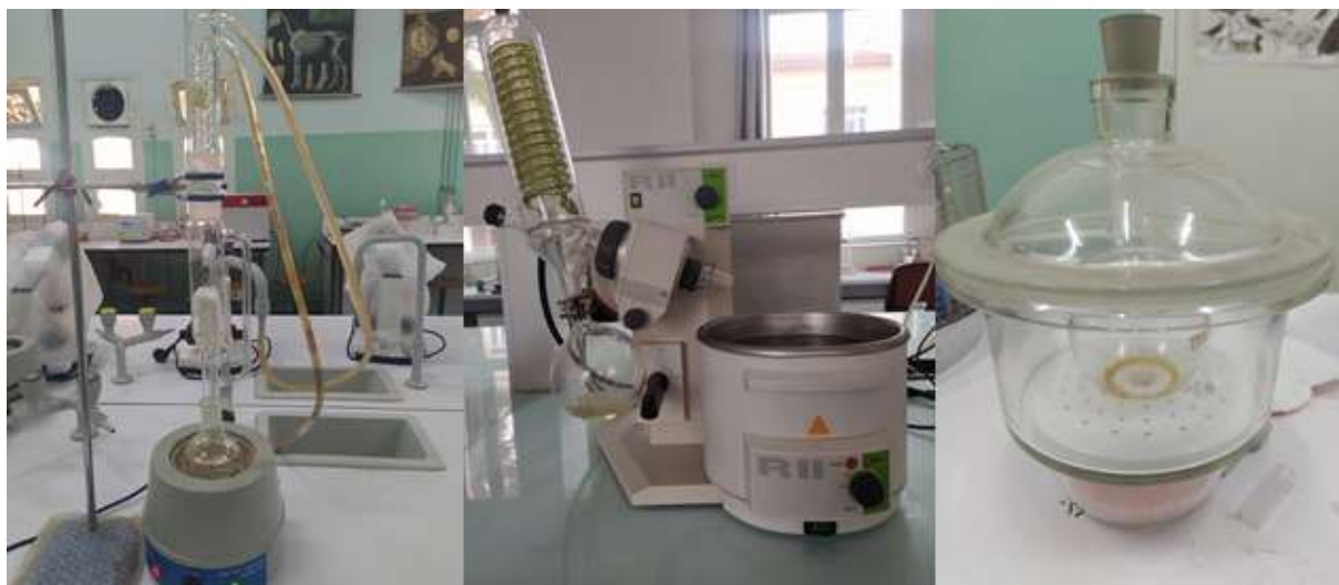
Figure 22 : Photo représentative du dispositif ; soxhlet, rotavapeur et dessiccateur (original).
