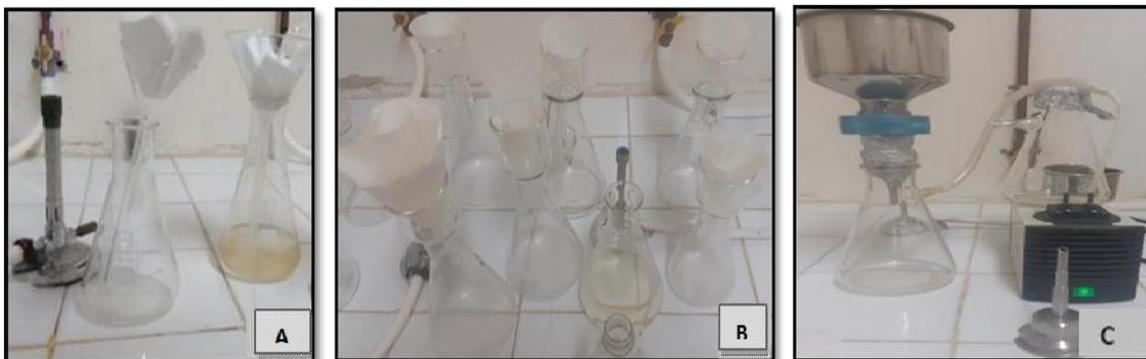
**Figure 15:** Filtration du bouillon de culture. (A) : par compresses stériles. (B) : par papiers filtre stérile. (C): Pompe de filtration (micro filtre 0,22  $\mu\text{m}$ ).
