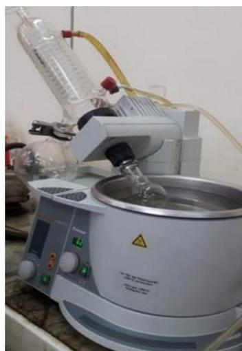
**Figure18 :** Evaporation du solvant de la phase organique par rotavapeur (Type BUCHI).
