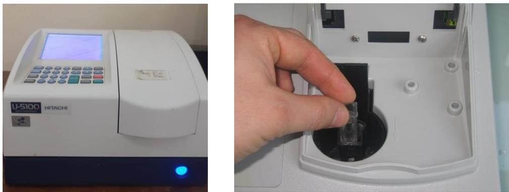
**Figure 21 :** Détection de la présence des nanoparticules par spectrophotométrie (HITACHI U-5100).
