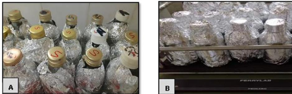
**Figure14 :** Fermentation des cultures fongiques. (A) : Flacons de PDB fermés par du papier aluminium contenant les disques mycéliens de *B.bassiana* (Sn182), *C.rosea* (G133), (C312). (B): l'agitation horizontale des Flacons.
