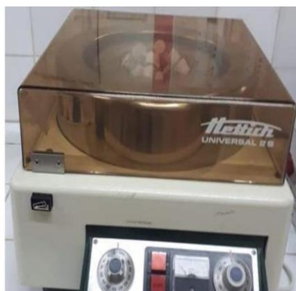
**Figure 16:** Centrifugation du filtrat de culture à 1500 tour /min pendant 20 mn.
