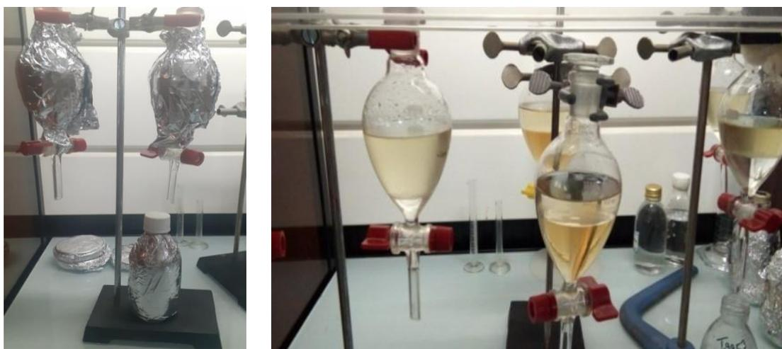
**Figure17 :** Extraction avec chloroforme et acétate d'éthyle dans des ampoules à décanter et la récupération de la phase organique.
