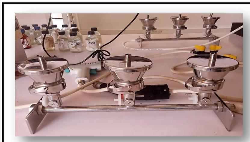
Figure n°12 : La rampe de filtration (originale).
