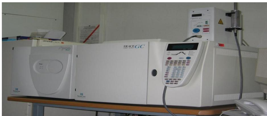
**Figure 08 :** Appareil de chromatographie en Phase Gazeuse couplée à la spectrophotométrie de masse (Moussaoui, 2011).
