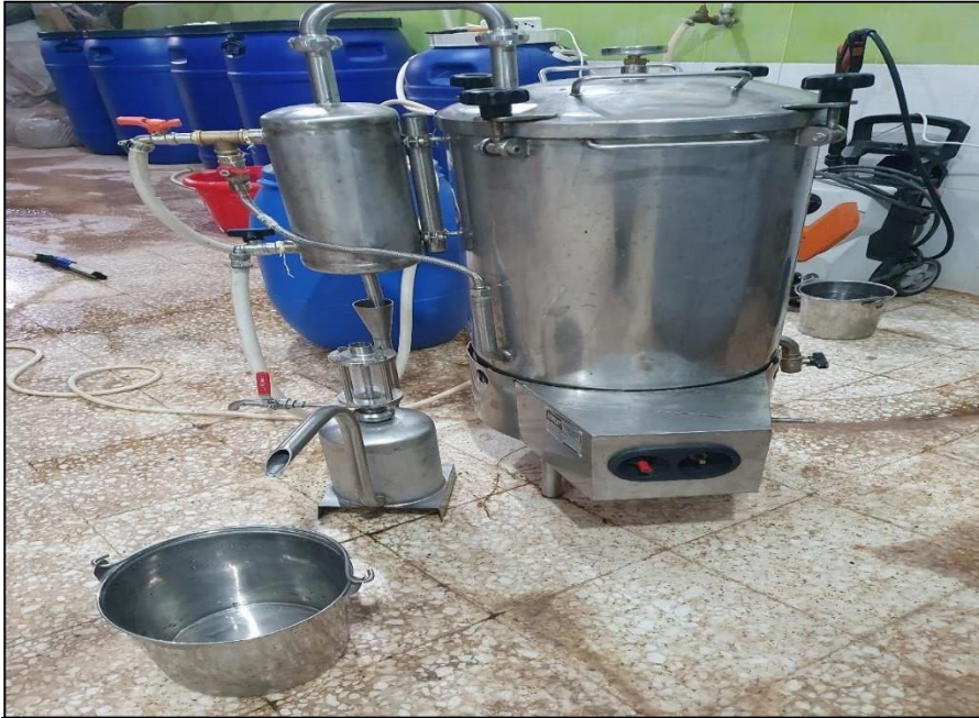
Figure-16- : Extraction d'huile essentielle du pin maritime par hydrodistillation
