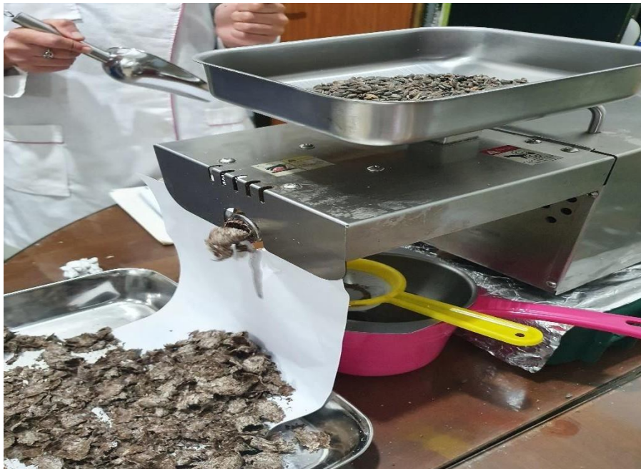
Figure-17- : Extraction d'huile végétale par la presse à froid
