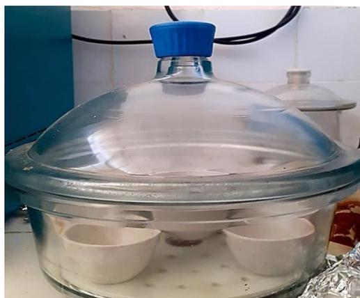
**Figure 8 :** Capsules en céramique des échantillons de fruits de fraise refroidissent au dessiccateur (**Originale, 2022**).
