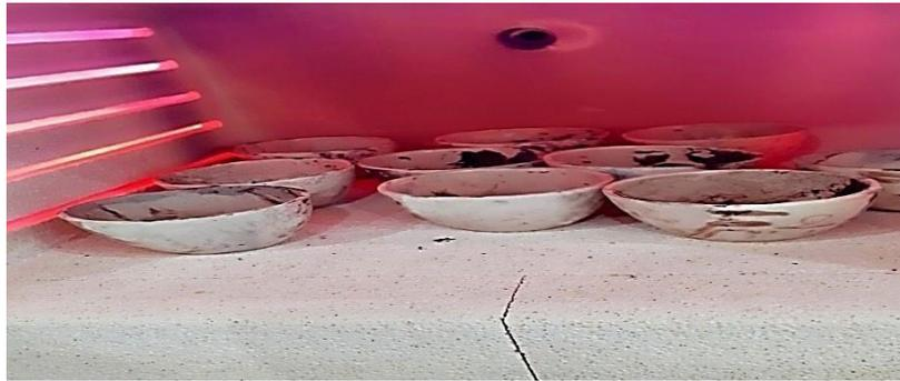
**Figure 6 :** Capsules en céramique des échantillons de fruits de fraise séchés incinérés dans le four à moufle (**Originale, 2022**).
