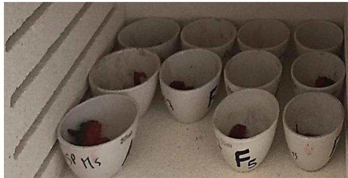
**Figure 5** : Capsules en céramique des échantillons de fruits de fraise incinérés dans le four à moufle (**Originale, 2022**).
