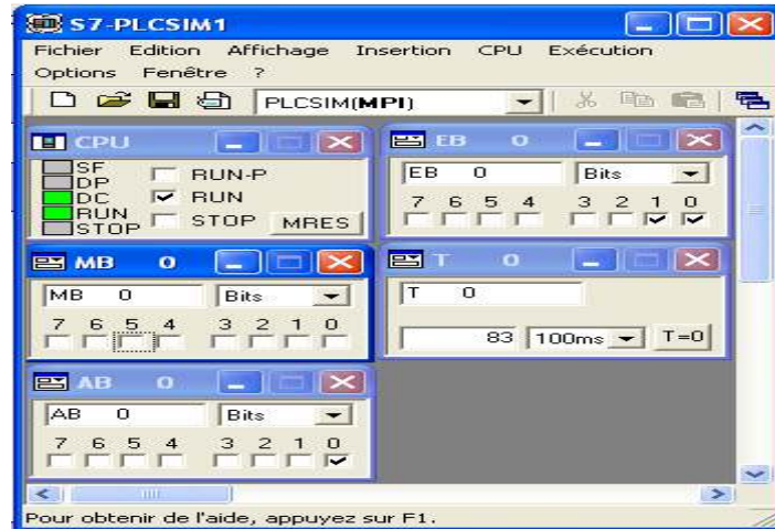
Figure 3.21. Exemple de simulation avec S7-PLCSIM1.
