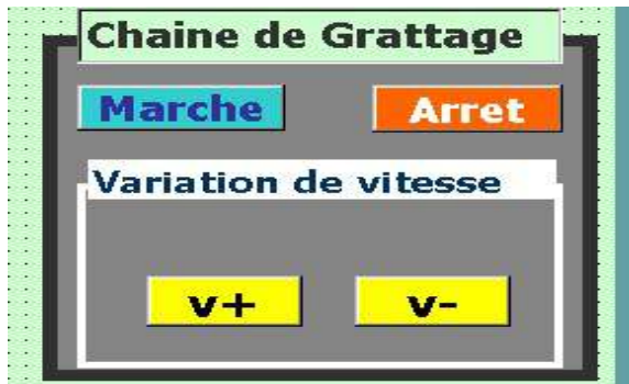
Figure 4.11. Commande moteur de la chaine.
