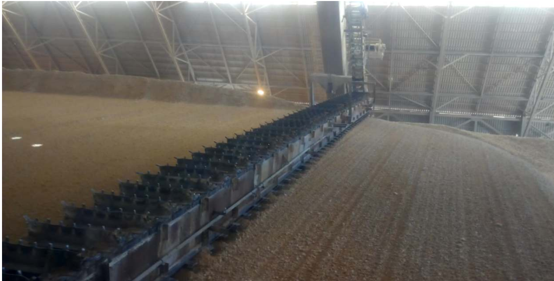
Figure 2.5. Système d'entraînement de la chaîne.
