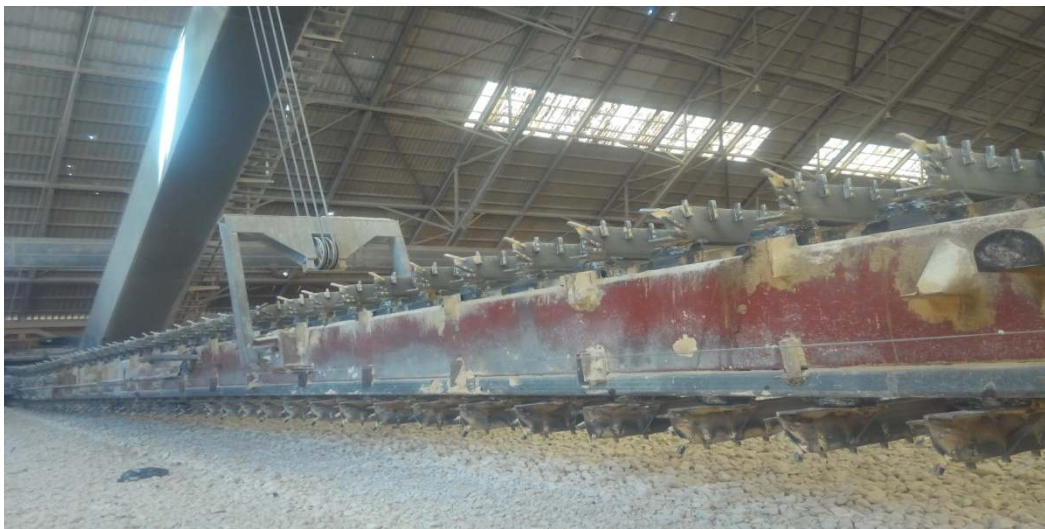
Figure 2.2. Système de levage et descente de la flèche.
