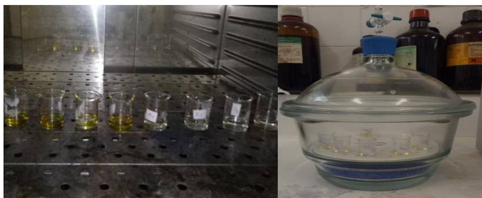
Figure IV.3 : Les huiles dans une étuve pendant 1 heure Après dans le dessiccateur 30mins. (Photo originale 2022).
