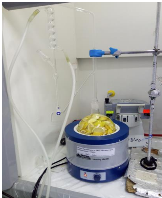
Figure IV.1 : Montage d'hydrodistillation type Clevenger. (Photo originale 2022).
