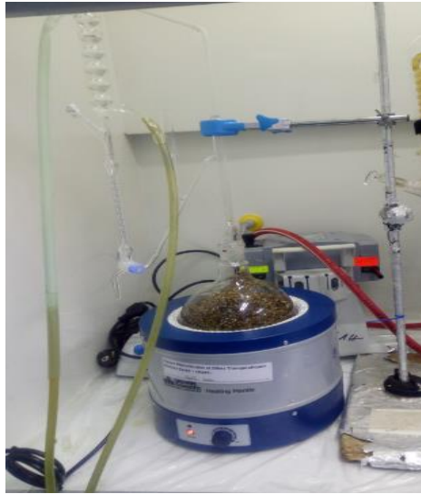
Figure montre l'extraction d'huile essentielle du thym (Photo originale 2022).
