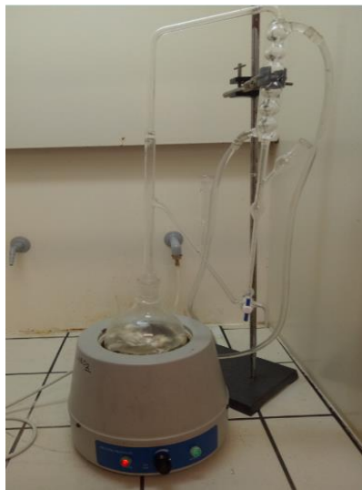
Figure montre l'extraction d'huile essentielle de l'ail (Photo originale 2022).
